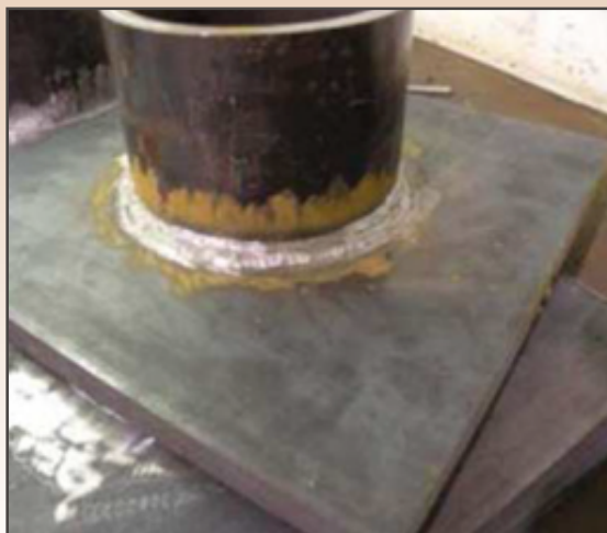
Figura 1.45 - Exemplo da soldagem em todo contorno. Fonte: PECLY, 2018.
