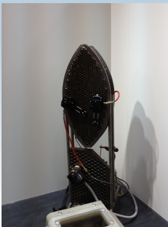
Figura 2.39 - TIG orbital na soldagem de tubos no espelho de um trocador de calor. Fonte: SATURNO, 2012.
