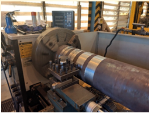
Figura 7.24 – Eixo no torno e croqui dos chanfros (Dimensões em mm). Fonte: OS AUTORES.
