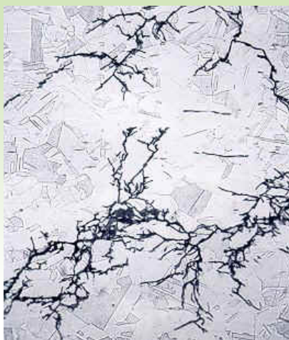
Figura 5.105 – Trincas de Corrosão Sob Tensão. Fraturas Transgranulares em A 316. Fonte: Corrosion Doctors
