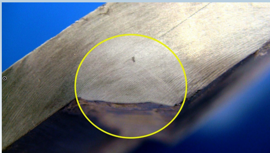
Figura 2.51 – Falta de fusão no GTAW. Fonte: PETERSON, 2011.
