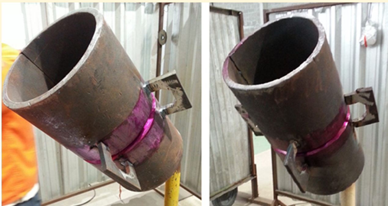
Figura 7.5 – Detalhe do posicionamento do tubo na condição 6G, unidos com “cachorros”, dispositivo de fixação de metais de base. Fonte: OS AUTORES, 2019.
