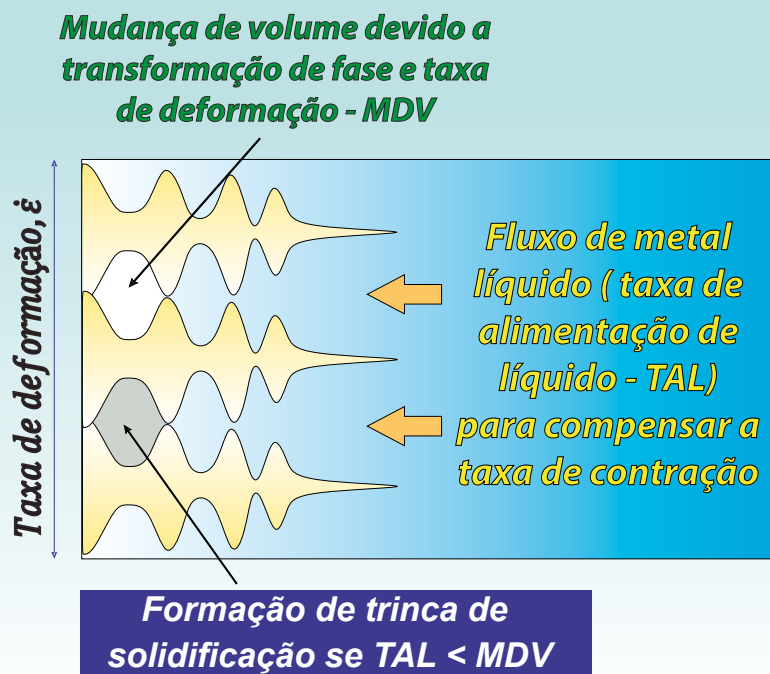
Figura 6.30 – Modelo de taxa de alimentação de líquido (TAL) e taxa de superfície. Fonte: o autor
