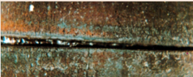
Figura 1.22 – Fotos de falta de penetração Fonte: AWS VIW-M, 2008, p. 2-2 a 2-4.
