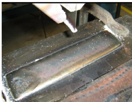
Figura 2.107 – Cordões de solda feitos por Strip Cladding. Fonte: Aula de processos de soldagem, Marcy Saturno, Especialização em Soldagem, 2017.
