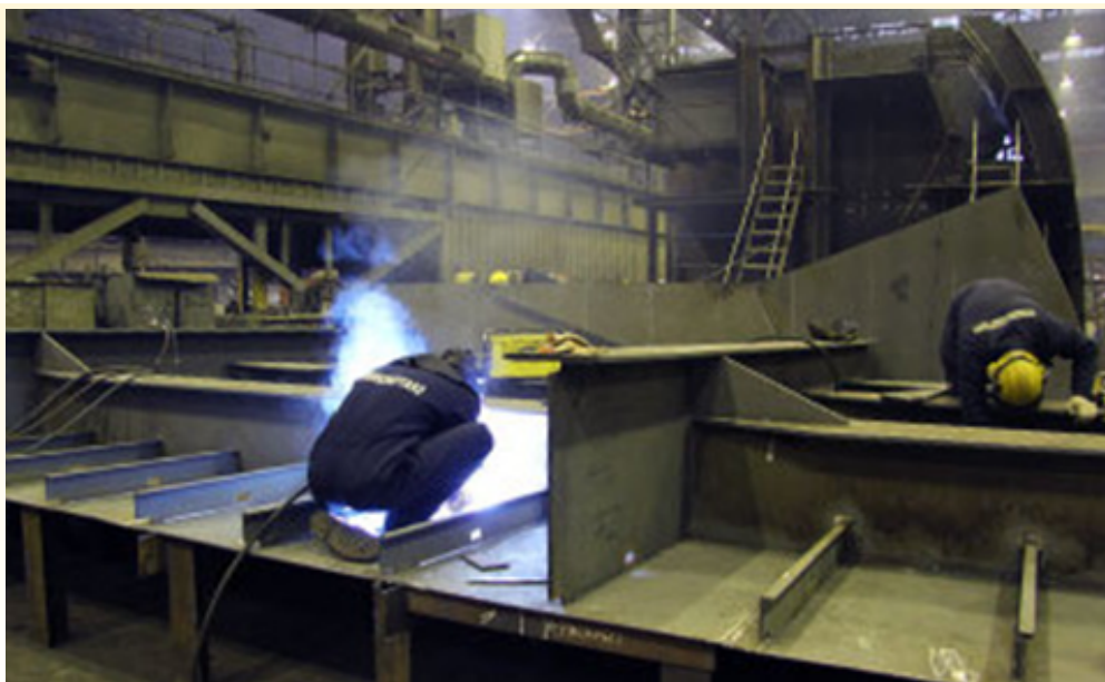
Figura 8.7 - Painéis soldados do vaso de separação de gás do estudo de caso 3. Fonte: OS AUTORES, 2018.
