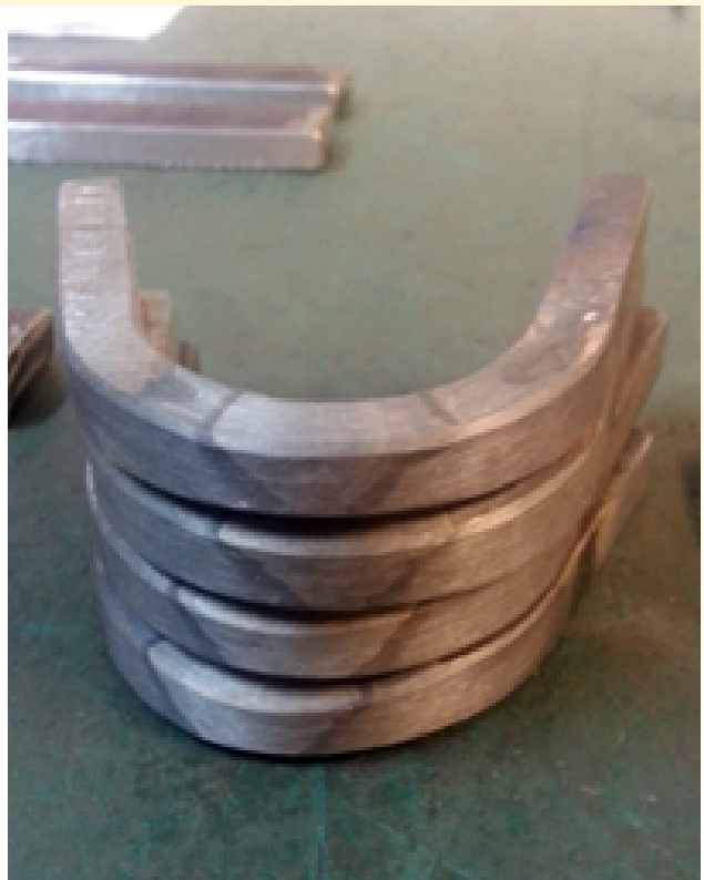
Figura 7.17 – Operação de ensaio de dobramento na prensa hidráulica. Fonte: OS autores.
