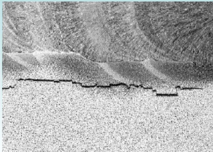
Figura 6.141 – Morfologia típica da decoesão lamelar. Fonte: adaptado de apostila Descontinuidades de Junta Soldada , Arno Cersosimo, 2012
