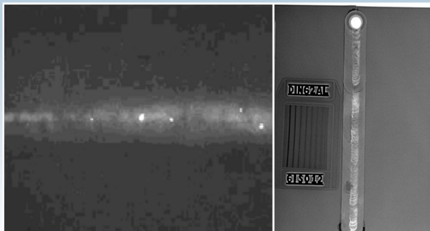
Figura 2.52 – Inclusão de tungstênio no GTAW. Fonte: NISHANT; KUMAR; SIVASHANMUGAM, 2014, p. 751.
