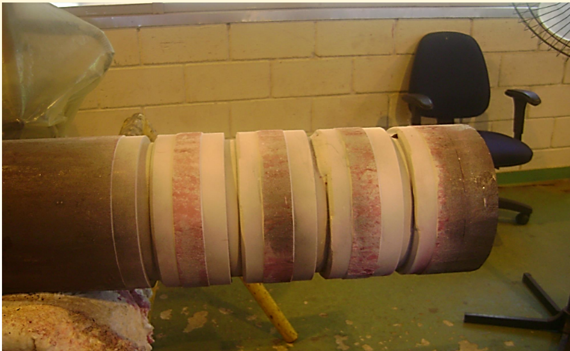
Figura 7.34 – Registro do ensaio de LP isento de descontinuidades. Fonte: OS AUTORES.
