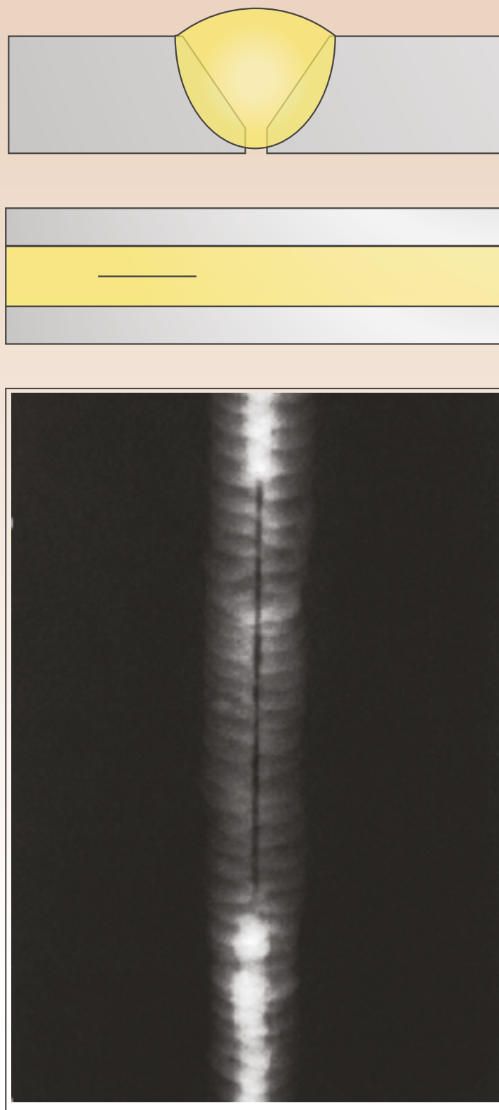
Figura 1.23– Terminologia das discontinuidades – falta de penetração. Fonte: ADAPTADA DE QUITES, 2009.
