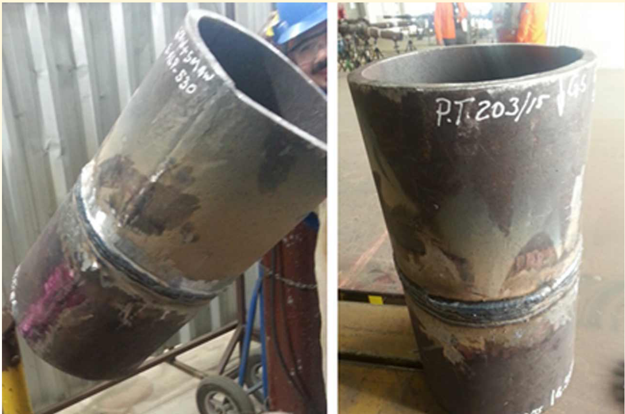
Figura 7.9 – Ilustração dos cordões de solda referentes aos passes de enchimento e acabamento. Fonte: OS AUTORES, 2019.
