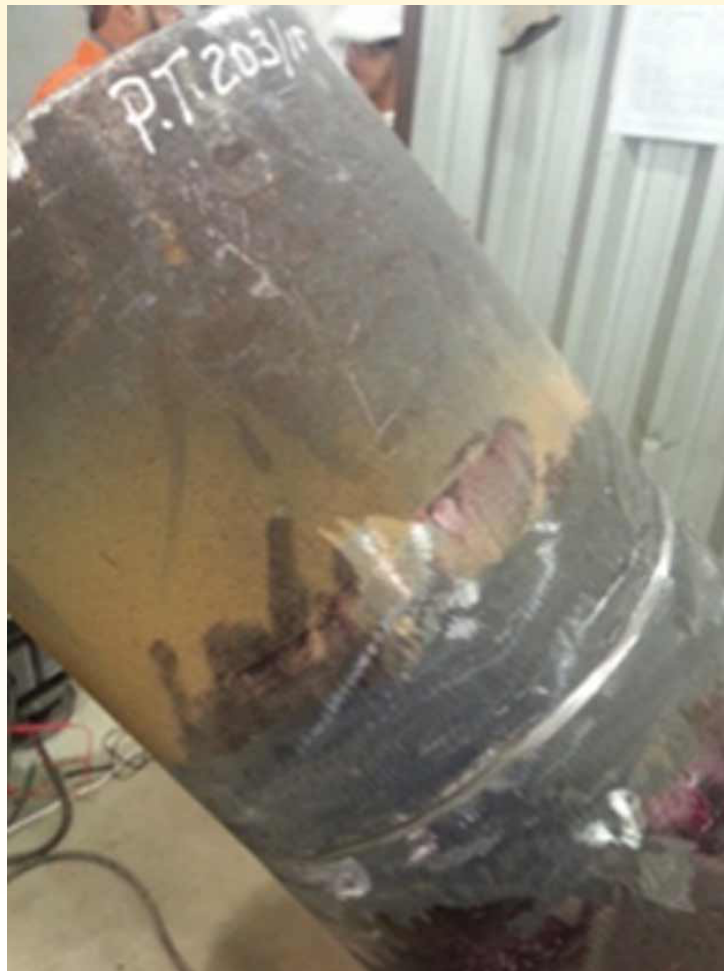
Figura 7.8 – Passe de raiz completo após limpeza. Fonte: OS AUTORES, 2019.
