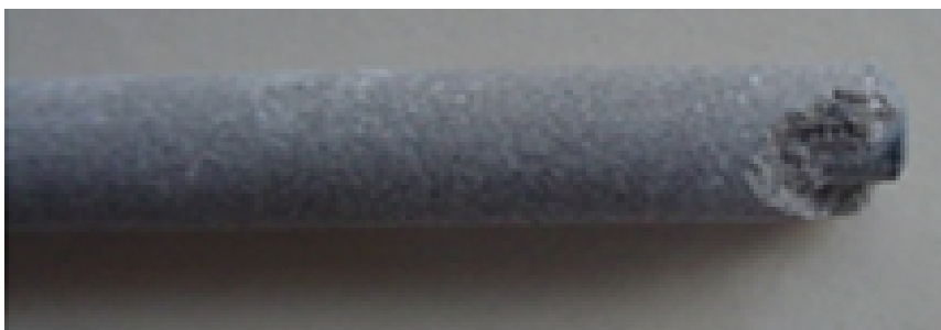
Figura 2.16 - Danos na ponta de arco. Fonte: SENAI, 2011.
