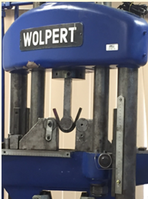
Figura 7.17 – Operação de ensaio de dobramento na prensa hidráulica. Fonte: OS autores.
