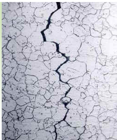
Figura 5.106 – Trincas de Corrosão Sob Tensão. Fraturas Intergranulares em Inconel. Fonte: Corrosion Doctors
