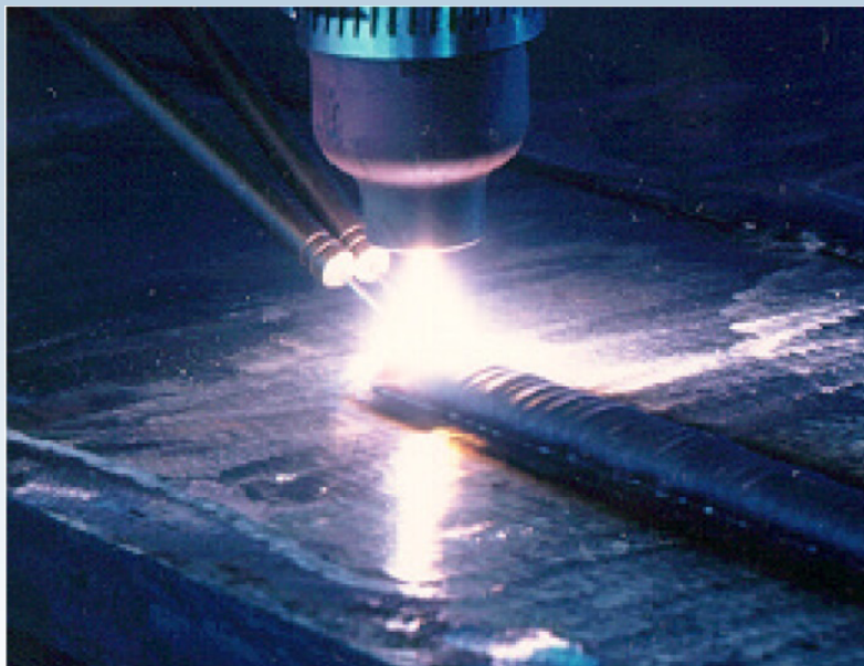
Figura 2.45 - Modo de alimentação com consumível conduzindo (twin wire GTAW). Fonte: ZHANG et al., 1999, p. 3.
