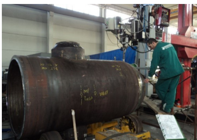
Figura 8.17: Identificação das soldas W2 e W3. Fonte: OS AUTORES, 2018.
