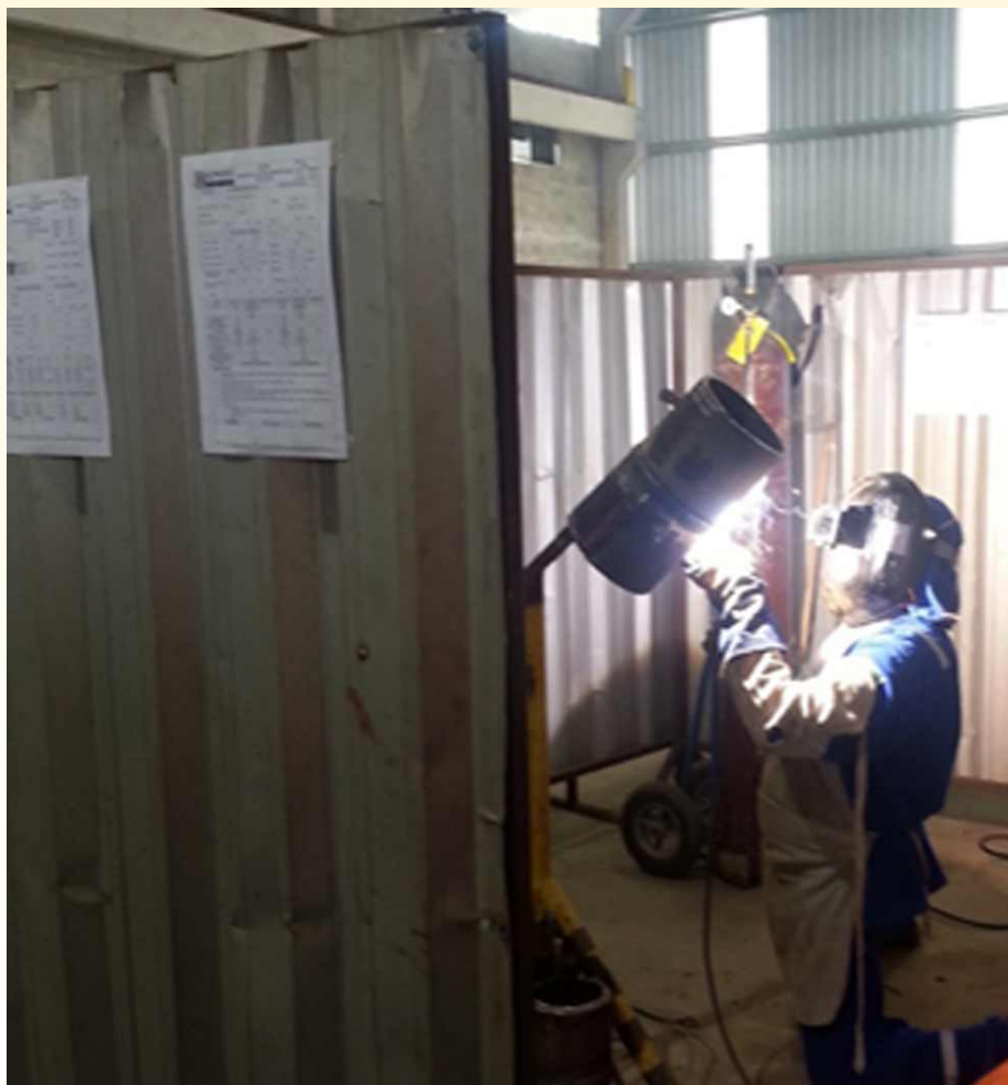
Figura 7.7 – Soldador posiciona o eletrodo e a vareta GTAW, abre o arco elétrico e inicia o processo de soldagem. Fonte: OS AUTORES, 2019.
