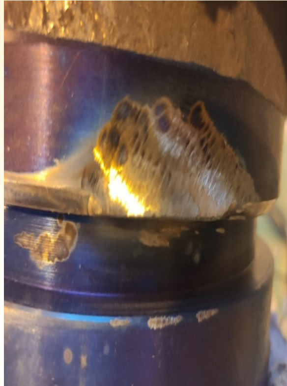
Figura 7.31 – Espessura recomposta com eletrodo ER70S-3 após esmerilhamento. Fonte: OS AUTORES.
