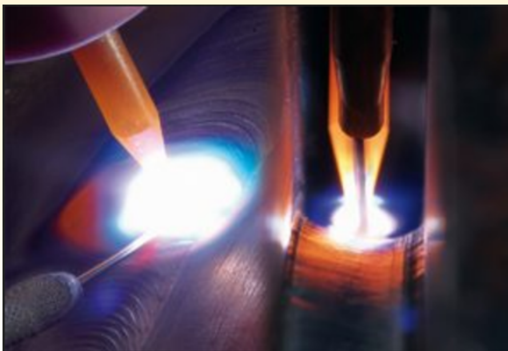
Figura 7.149 – poça de fusão na posição plana de ligas de cobre. Fonte: EAD de soldagem de materiais não ferrosos.
