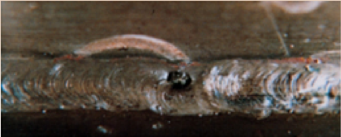
Figura 1.28 – Junta soldada com inclusão de escória. Fonte: AWS VIW-M, 2008, p. 2-2 a 2-4.
