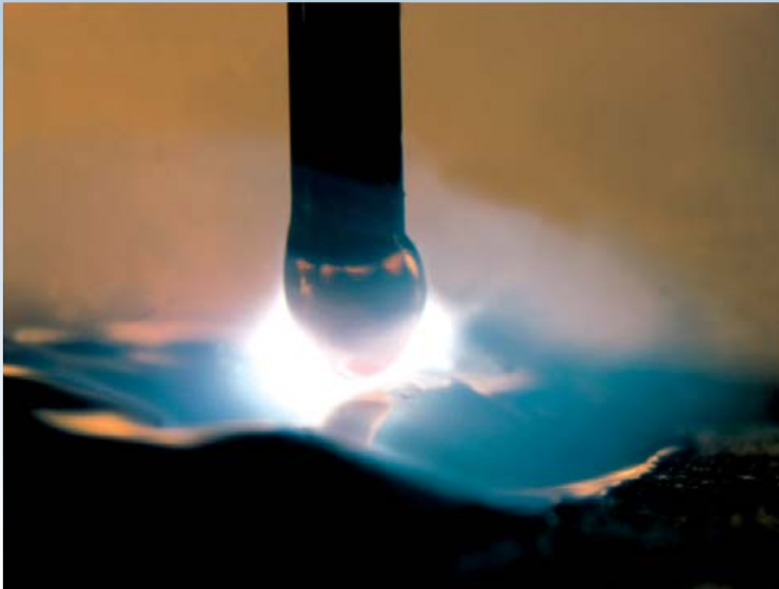
Figura 2.66 – Modo de transferência por curto-circuito. Fonte: A SOLDAGEM, [?].
