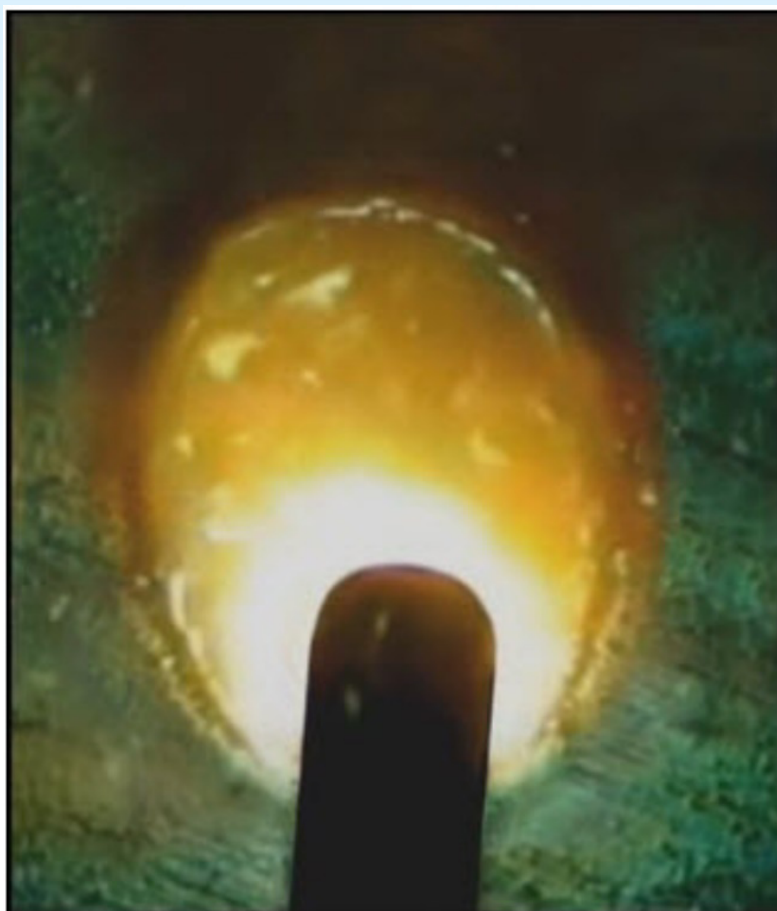
Figura 3.1– Poça fundida na soldagem SMAW. Fonte: WCWELDING. Arc welding tips and tricks! Disponível em: https://www.wcwelding.com/arc-welding-tips.html . Acesso em: 8 out. 2018.
