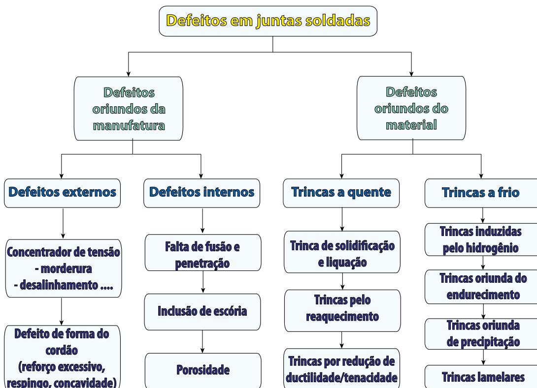
Figura 6.1 – Defeitos em juntas soldadas. Fonte: o autor
