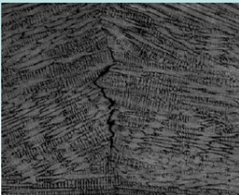
Figura 6.45 – Trinca de solidificação em Aço tipo 310. Fonte: apostila Descontinuidades de Junta Soldada , Arno Cersosimo, 2012.
