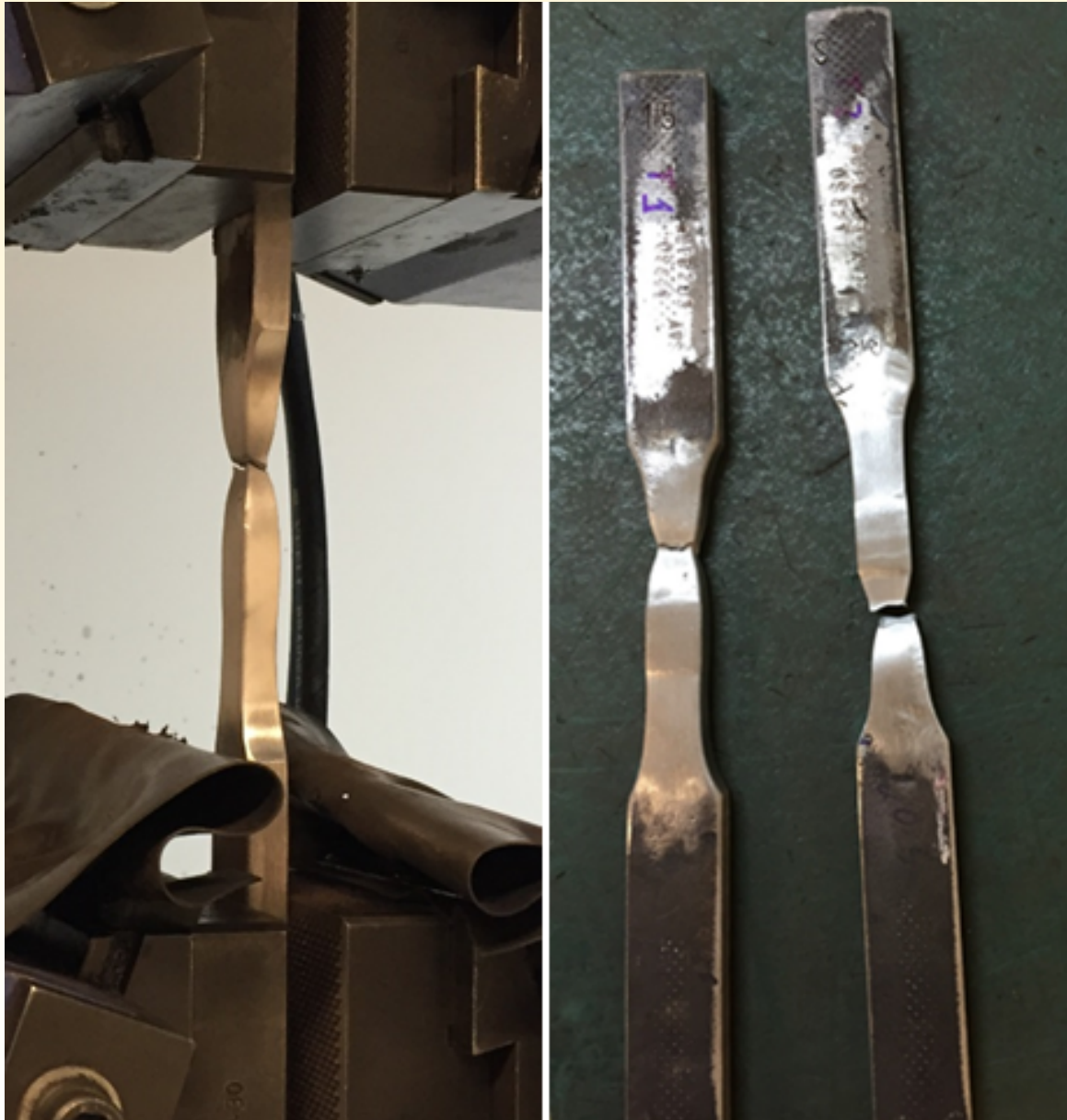
Figura 7.15 – Detalhe da região da fratura nos corpos de prova durante a realização do ensaio de tração. Fonte: os autores.
