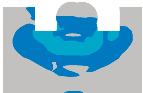
Figura 7.51 – Tensão residual do vinco V. Fonte: Imagem cedida pela ESI.
