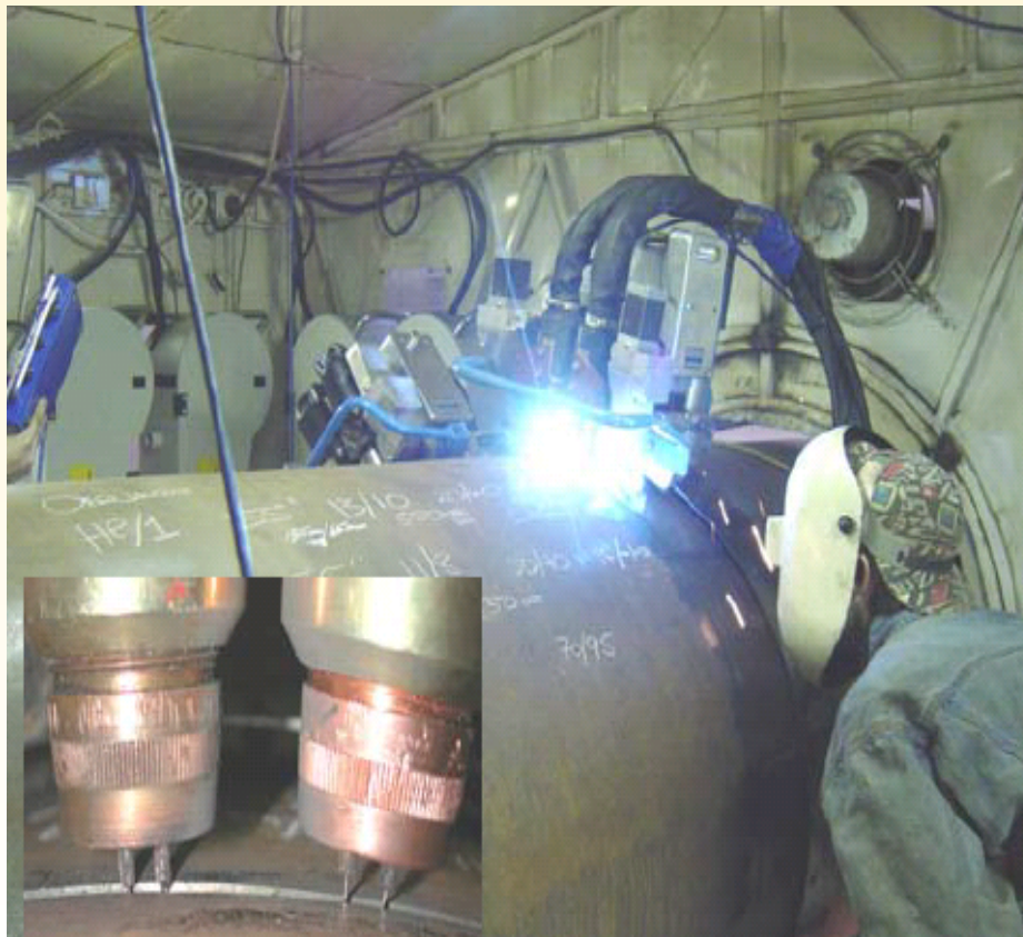
Figura 7.59 – Processo CAPS dual tandem . Fonte: os autores.
