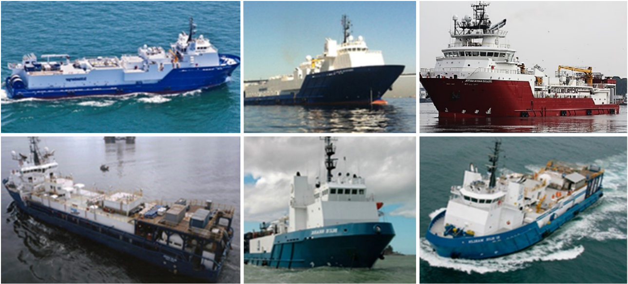
Figura 3.4.1 Barcos de estimulação já empregados ou ainda em operação no Pré-sal entre 2013-2020. As embarcações possuem posicionamento dinâmico, DP2, e as principais Companhias de Serviço proveem esse tipo de recurso.
