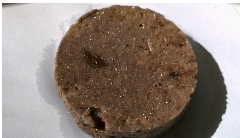
Figura 6.2.1 Cristais de anidrita (pontos brancos) precipitados em plugue de carbonato após ensaio de reator com água do mar e CO 2 , 130°C e 4.000 psi.
