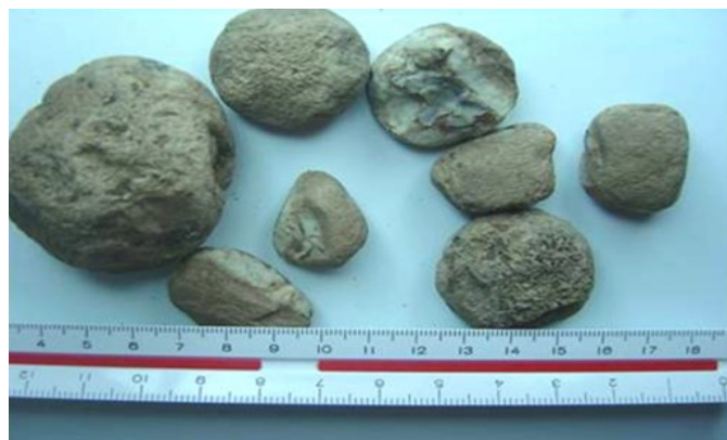
Figura 7.1.1.1 Carbonato de cálcio (aragonita) precipitado durante a produção e carreado até a planta de processo.
